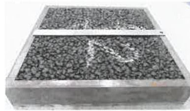
Figura 16. Aspecto de las probetas después del ensayo de pista.
