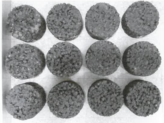
Figura 9. Aspecto de las probetas de mezcla bituminosa.
