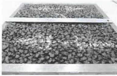
Figura 16. Aspecto de las probetas después del ensayo de pista.
